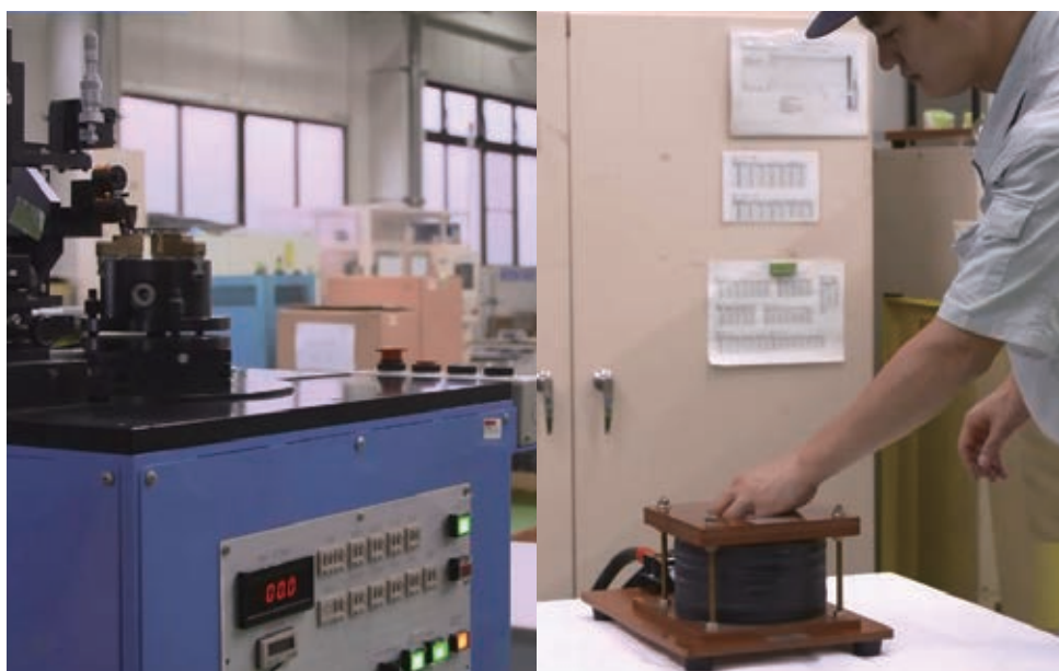
着磁装置による磁化作業
