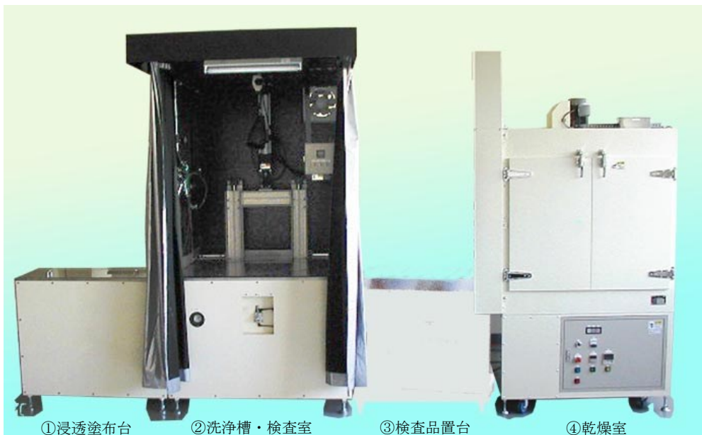
①浸透塗布台 ②洗浄槽・検査室 ③検査品置台 ④乾燥室
